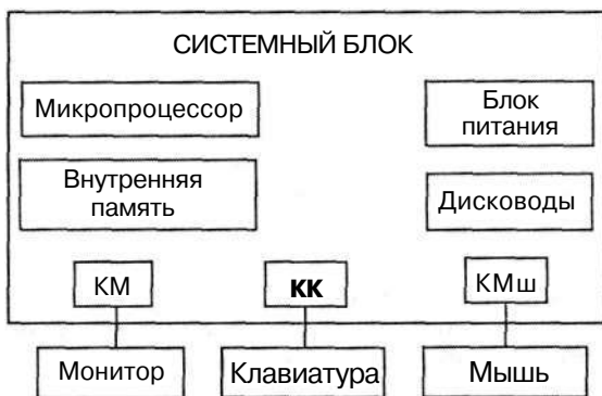
Рис. 2.7. Минимальный комплект устройств ПК. КМ — контроллер монитора, КК — контроллер клавиатуры, КМш — контроллер мыши
