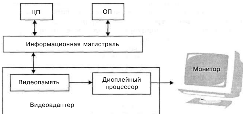
Рис. 4.7. Схема системы вывода изображения на экран.
