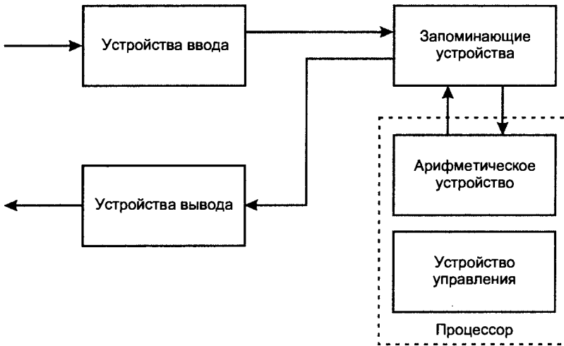
Рис. 3.1. Функциональная схема ЭВМ
